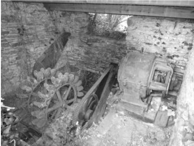
LLUN 3 Rhôd pelton ddwbl a chynhyrhydd trydan ar gyfer y pentref yn 'Wern', Talybont, Ceredigion/ Double pelton wheel and generator for lighting the village at 'Wern', Talybont, Ceredigion (John Crompton, 2016)
