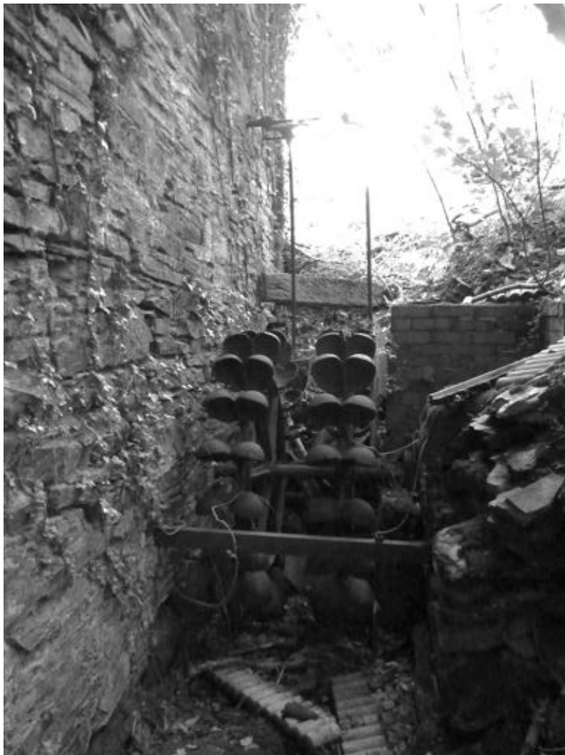
LLUN 8 Olwyn pelton ddwbl yn Ffatri Wlân Ceulan, Talybont, Ceredigion/ Double pelton wheel at Ceulan Woollen Mill, Talybont, Ceredigion (John Crompton, 2016)
